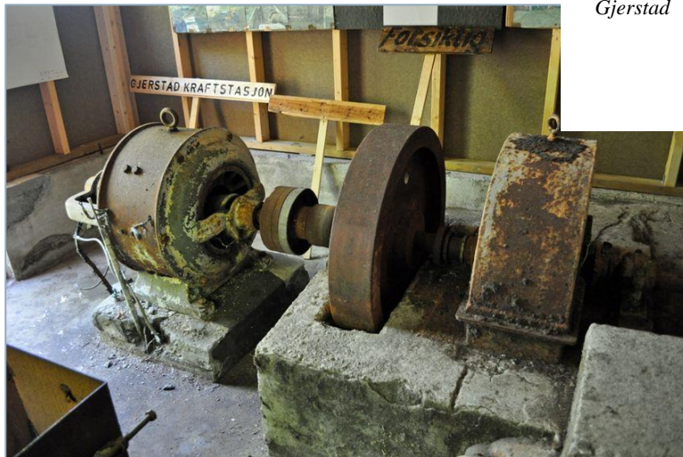
Generator, svinghjul og turbin frå kraftstasjonen på Gjerstad
